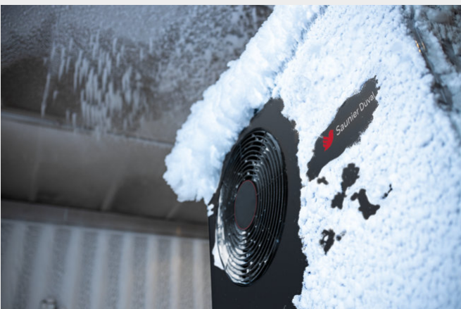
La resistencia a condiciones meteorológicas extremas se prueba ampliamente en nuestra cámara climática.
